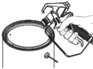
8. Заблокируйте краскораспылитель, надавив на предохранитель спускового механизма и переведя его в заблокированное положение (смотрите руководство на краскораспылитель).
