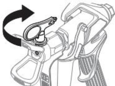
4. Один раз нажмите на спусковой механизм краскораспылителя, чтобы удалить загрязнение высоким давлением. НИКОГДА не используйте сопло в обратном положении БОЛЬШЕ ЧЕМ ДЛЯ ОДНОГО нажатия спускового механизма за один раз. Можете повторить эту процедуру, пока сопла не будет свободен от загрязнения.
