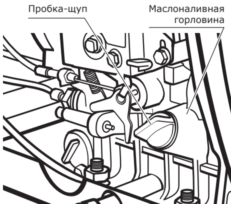
Рис. 8. Заполнение масляного картера и контроль уровня масла
