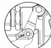
Предохранитель спускового механизма в заблокированном положении
