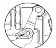
ПРЕДОХРАНИТЕЛЬ СПУСКОВОГО МЕХАНИЗМА В ЗАБЛОКИРОВАННОМ ПОЛОЖЕНИИ
