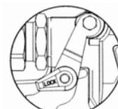
Предохранитель спускового механизма в заблокированном положении
