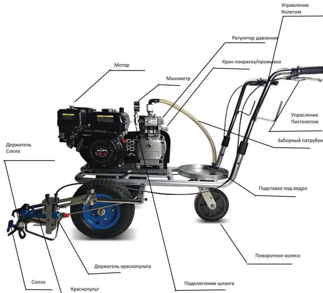
В безвоздушная установка для распыления с высоким давлением используется высоконапорная диафрагма поршня для создания давления покрытия до 3000 psi (210 бар). Затем покрытие подается в краскораспылитель по шлангу высокого давления. При сбросе давления из форсунки и распылении образуется плотное покрытие на поверхности стены. Поскольку для распыления не требуется сжатый воздух, мы называем его безвоздушным распылением.
