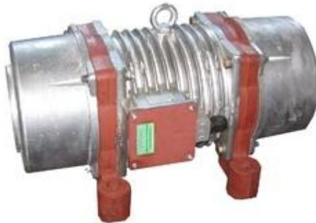
Вибраторы общего назначения повышенной надежности обозначаются маркой «Н».
