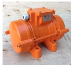
сыпучих материалов. При разгрузке вагонов с сыпучем веществом, вибратор крепится к днищу или боковым сторонам, что этим облегчает и ускоряет работу. Применяются при изготовлении бетонных блоков, кирпичей, тротуарной плитки и различных форм связанных с бетоном. Во время работы вибратора материал в прессформах уплотняется, выходит воздух, заполняются пустоты и получается монолитная форма изделия.
